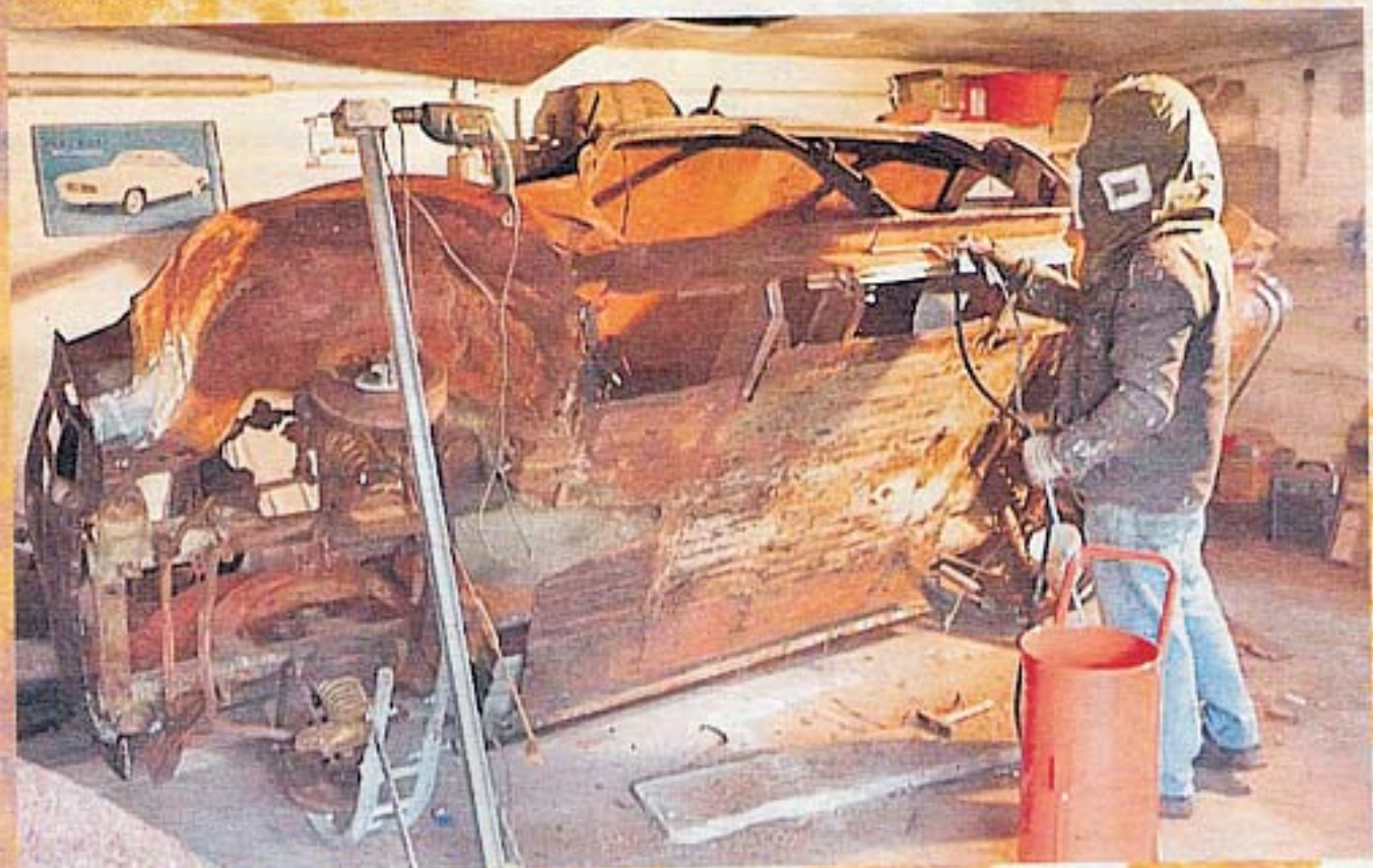
Der Hansa während der Schweiß- und Sandstrahlarbeiten ...
